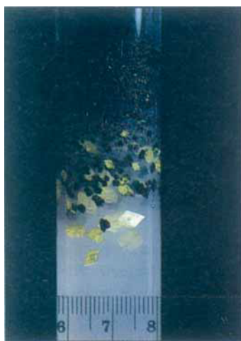
Abb. 15. Gelzüchtung von Silberperiodaten durch pH-Absenkung ( \text{AgNO}_3 , \text{H}_3\text{IO}_6 und Natriumsilicatgel). Gelbe Kristalle: \text{Ag}_2\text{H}_3\text{IO}_6 ; rotbraune (hier schwarze) Kristalle: \text{Ag}_2\text{IO}_5 [124].
